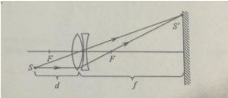
2. Фокусное расстояние рассеивающей линзы нельзя определить напрямую, так как она дает мнимое изображение ( $f < 0$ ), расстояние до которого нельзя измерить линейкой. Поэтому используют систему линз: рассеивающую линзу объединяют с собирающей (см. рисунок), оптическая сила которой по модулю больше. При этом будет получено действительное изображение объекта, а оптическая сила  $D$  линз равна:
