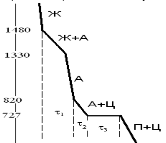
Рис. Кривая охлаждения железоуглеродистого сплава с содержанием углерода 1%.
