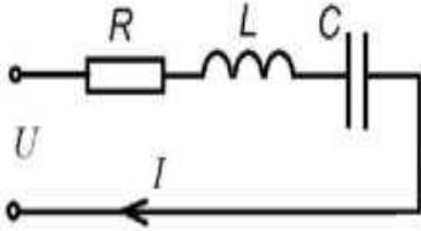
16. В цепи переменного тока с индуктивностью  $0,15\ \text{Гн}$  и активным сопротивлением  $50\ \text{Ом}$ , включенными последовательно, ток изменяется с частотой  $314\ \text{рад/с}$ . Определить полное сопротивление цепи, напряжение сети, активную, реактивную и полную мощности, если максимальное значение тока  $2,82\ \text{А}$ . Нарисовать векторную диаграмму напряжений.
