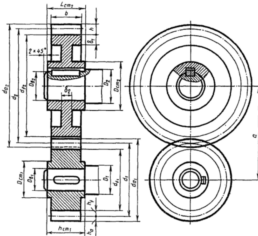
Соотношение размеров элементов цилиндрической зубчатой передачи в зависимости от модуля  $m$ , чисел зубьев шестерни  $z_1$  и колеса  $z_2$  и диаметров валов шестерни  $D_{a1}$  и колеса  $D_{a2}$
